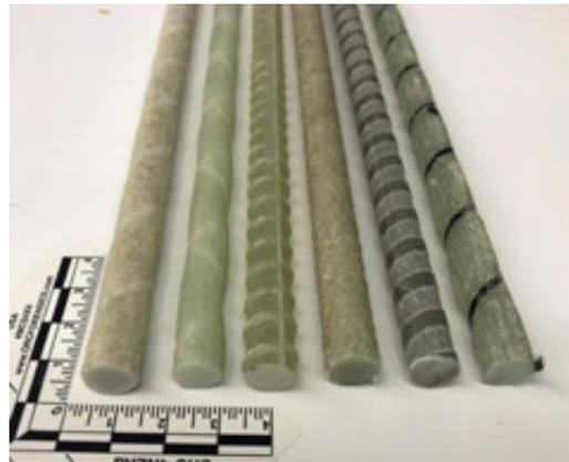
Figura 1. Barras GFRP con distintos acabados.
